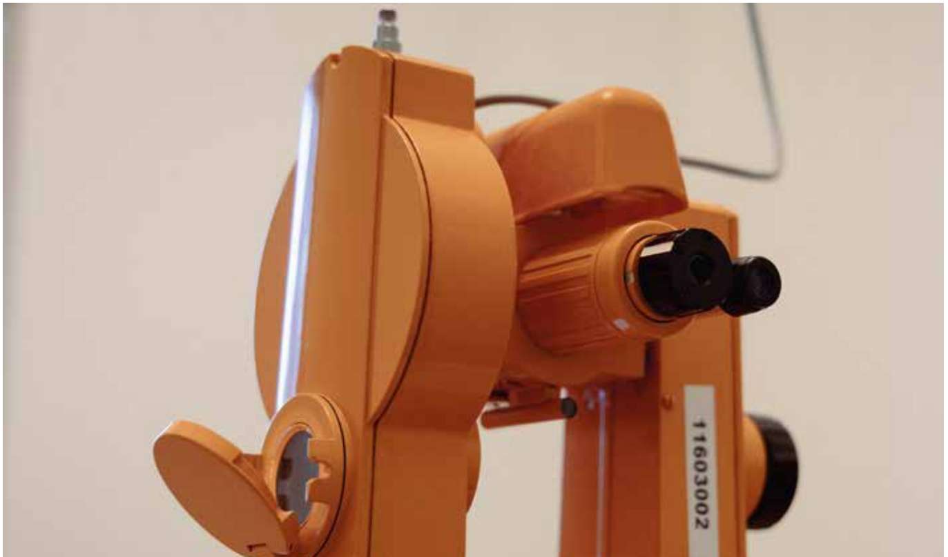
Bild 4.4: Inom observatorieverksamheten används en DI-fluxteodolit för att mäta magnetfältets baslinje vid magnetiska absolutmätningar.
